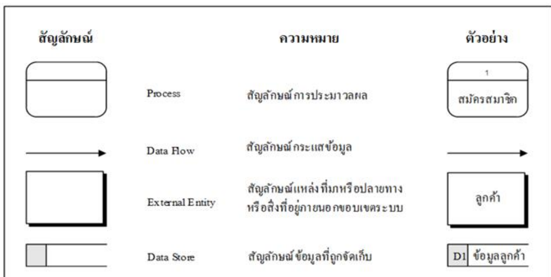
ภาพที่ 2.2 สัญลักษณ์ต่าง ๆ (ใช้สัญลักษณ์ของ Gane & Sarson)
